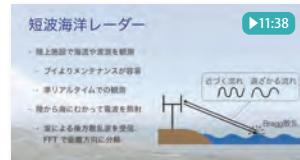
n番目のアンテナにndsinθ遅れて到達)、広い範囲の観測が可能。アンテナ1局では視線方向の流速のみが見えるが、2局以上あるとベクトル合成により流れの方向を計算できる。(▶14:22)
